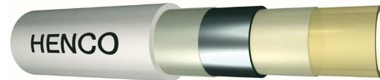
Трубы HENCO STANDARD состоят из сваренной встык алюминиевой трубы с внутренним и внешним слоями полиэтилена, которые были спиты с использованием электронных лучей. Различные слои соединены друг с другом с помощью высококачественного клея. Внутренняя и внешняя трубы изготавливаются из гранул полиэтилена (HDPE), которые были спиты с помощью электронных лучей.
