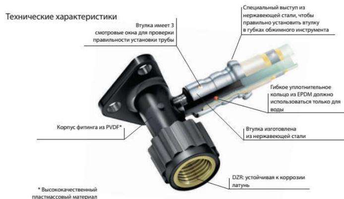
Пресс-фитинги HENCO - STANDARD отлиты из фторопласта ПВДФ, имеют уплотнения из высококачественного EPDM каучука, гильзы увеличенного размера из нержавеющей стали с выступом для центровки в пресс-инструменте. Резьбовые вставки выполняются из коррозионностойкой латуни DZR.
