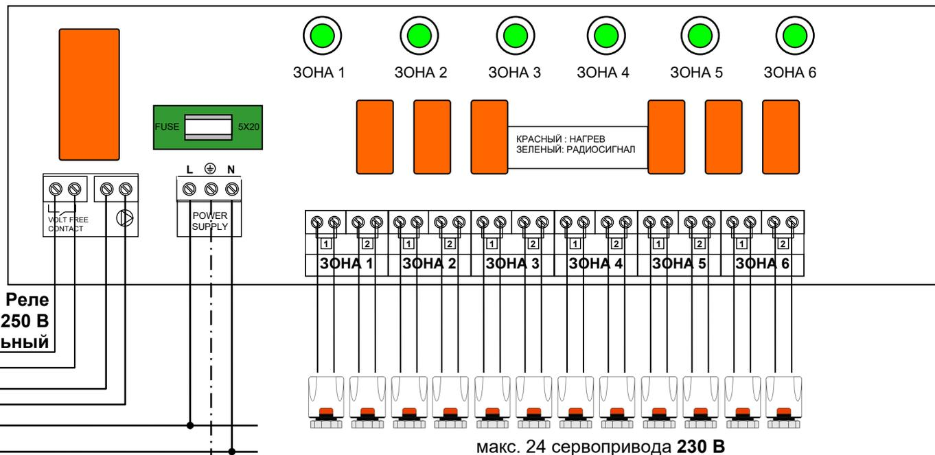
**Схема подключения модуля на 6 зон.**
